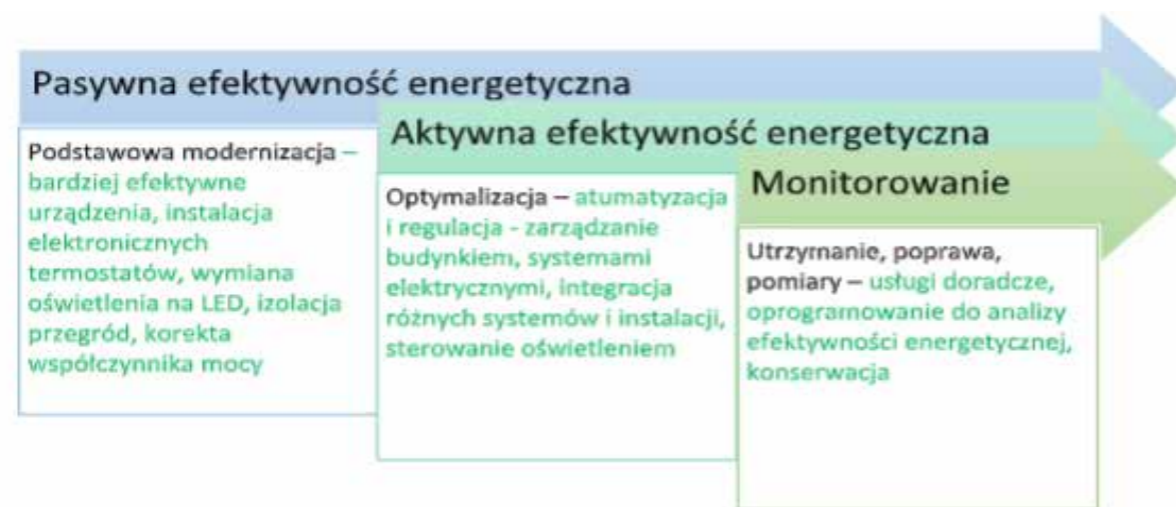
Wykres 3. Kolejność działań prowadzących do poprawy efektywności energetycznej i trwałego obniżenia kosztów
